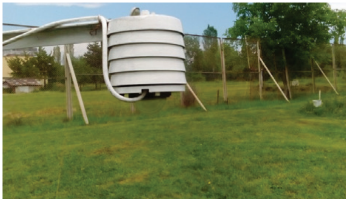
Фиг. 4.б. Пиранометър CMP11 уред за измерване на отразена слънчева радиация
