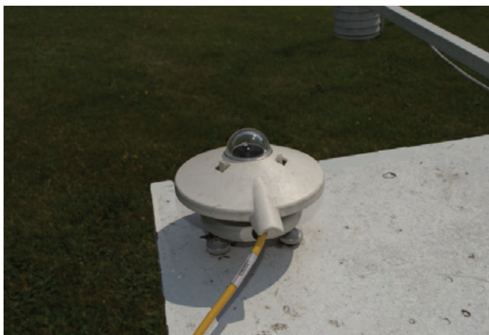
Фиг. 4.с. Пиранометър CMP-3 – уред за измерване на сумарна слънчева радиация
