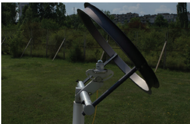
Фиг. 4.а. Пиранометър CMP 3 и уред CM 121 - Shadow Ring – уред за измерване на разсеяна слънчева радиация
